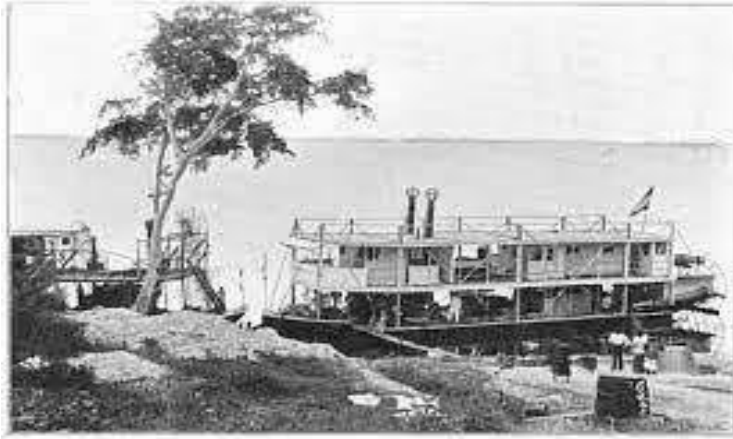
De Congo-stoomboot van de Afrikaansche Handelsvereniging met achter-radschoepaandrijving ter zekering van geringe diepgang
